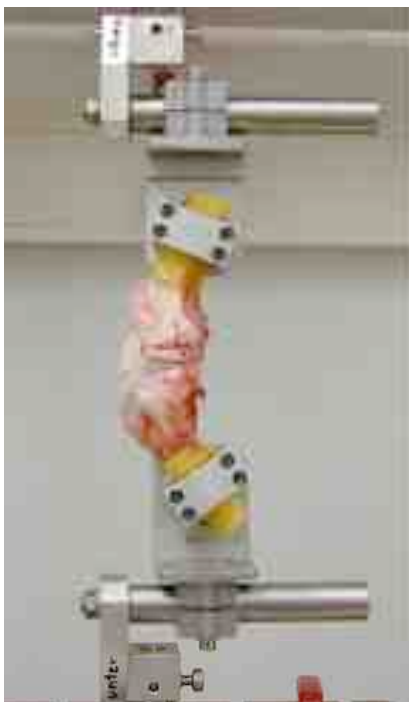
Abb. 2.5: Einspannvorrichtung zur axialen dynamischen Gelenkbelastung eines Kniegelenkpräparats in einer hydraulischen Materialprüfmaschine (Instron 8871, Instron Schenck Testing Systems GmbH, Darmstadt)
