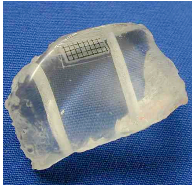
Abb. 2.13: Durchsichtiger Platzhalter des medialen Tibiaplateaus mit aufgeklebtem Millimetermaßstab und Querbohrungen zur Fixierung mit Kirschnerdrähten
